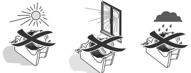
Si raccomanda espressamente di non installare l'apparecchiatura in ambienti difficili (presenza di sabbia, salsedine, ecc.). Nel caso in cui l'apparecchiatura debba essere installata in tali ambienti, incrementare la frequenza della manutenzione ordinaria in modo da mantenere l'apparecchiatura sempre pulita ed efficiente.
