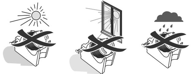
Il est vivement recommandé de ne pas installer l'appareil dans des environnements agressifs (en présence de sable, salinité, etc.). Si l'appareil doit être installé dans ce type d'environnement, procéder plus fréquemment aux entretiens courants de manière à ce que l'appareil reste toujours propre et efficace.
